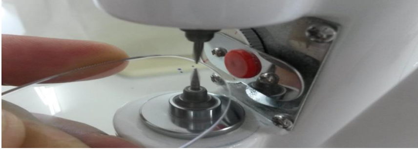
Şekil 3: Matkap ile Cama Delik Delme
